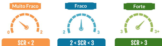
Figura 9.2 – Classificação da robustez de um sistema a partir do valor de SCR
